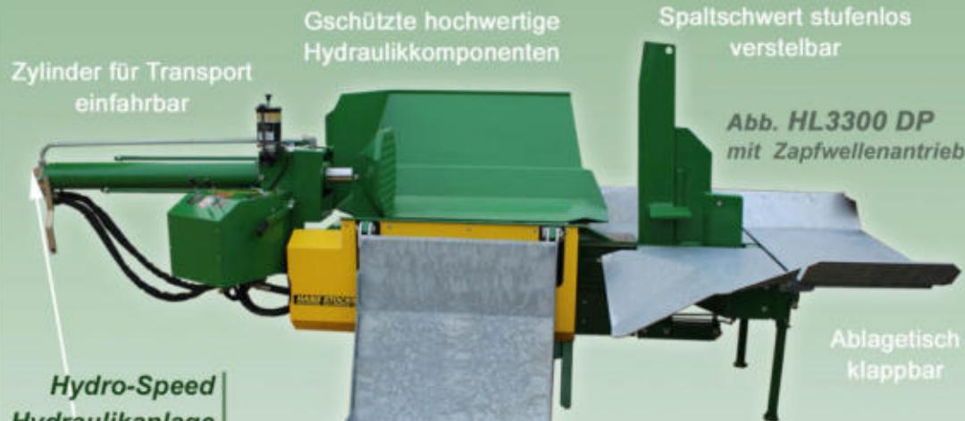
Abb. HL3300 DP mit Zapfwellenantrieb
