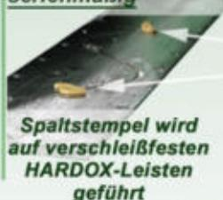
Spaltstempel wird auf verschleißfesten HARDOX-Leisten geführt
