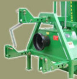
Zapfwellenantrieb (max. U/ min. 450)
