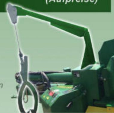
Seilwinde mit Eigenölversorgung und extra Pumpe
